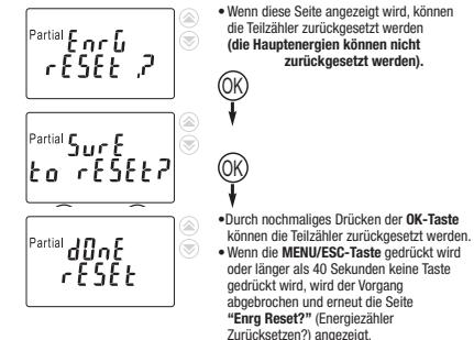
• Durch nochmaliges Drücken der OK-Taste können die Teilmeter zurückgesetzt werden.
